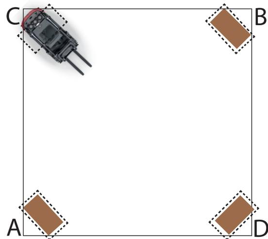
Stell den Palettenturm auf D ab. Danach müssen die oberen zwei Paletten beliebig auf A & B platziert werden. Der Stapler muss mit abgelassenen Zinken in der Ecke von C stehen. Auf dem Video muss auch zu sehen sein, wie die Paletten am Ende stehen.
