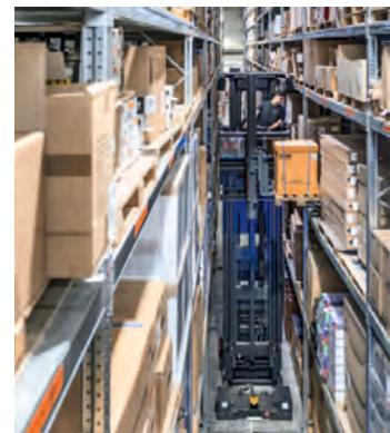
Das Linde-Assistenzsystem Dynamic Reach Control stabilisiert die K-Geräte seitlich beim Ausschleppen der Last.
