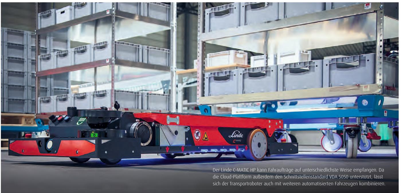
Der Linde C-MATIC HP kann Fahraufträge auf unterschiedlichste Weise empfangen. Da die Cloud-Plattform außerdem den Schnittstellenstandard VDA 5050 unterstützt, lässt sich der Transportroboter auch mit weiteren automatisierten Fahrzeugen kombinieren.
