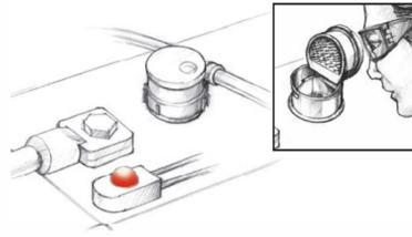
2. Nach Ladung Elektrolytstand kontrollieren (Elektrolytfüllstandsensor empfohlen)
