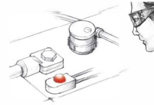
3. Kontrolle der Verbinder, Steckverbindungen und Anschlusskabel auf Beschädigungen
