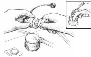
2. Nach der Ladung gereinigtes Wasser nachfüllen (Wassernachfüllsystem empfohlen) – optimaler Nachfüllzeitpunkt bei Einschichtbetrieb: Freitag morgen
