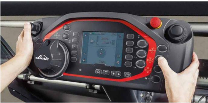
**Alles im Blick und im Griff.** Das standardmäßige Front-Bedienpult kann, passend für jeden Bediener, in Höhe, Abstand und Neigung eingestellt werden. Das vollgrafische Display zeigt alle relevanten Fahrzeugdaten wie Hubhöhe, Fahrgeschwindigkeit, Lastgewicht oder Batteriezustand an.
